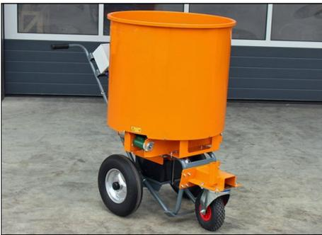
Das Einstreugerät verfügt über ein elektrisch angetriebenes Rührwerk. Das ebenfalls elektrisch angetriebene Förderband wirft das Einstreumaterial in die Liegebox. Die Förderbandgeschwindigkeit ist stufenlos einstellbar, wodurch sich die Einstreutiefe sehr genau bestimmen lässt. Die Menge des Einstreumaterials kann mit einem mechanischen Dosierschieber exakt eingestellt werden. Das Einstreugerät selber wird manuell bewegt.
