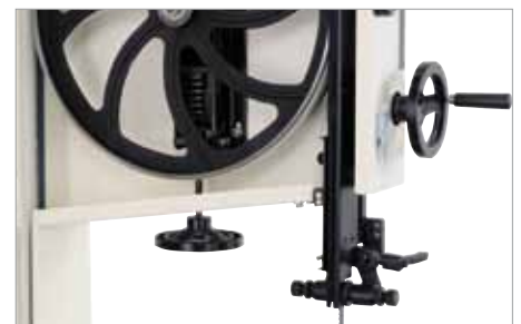
Feingewuchtete Grauguss-Speichenräder mit bombierter, langlebiger PU-Auflage
