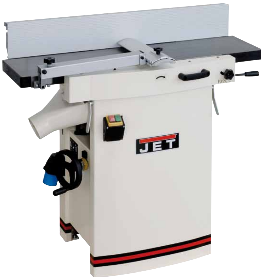
Sekundenschneller Wechsel von Abrichten auf Dickenhobeln
