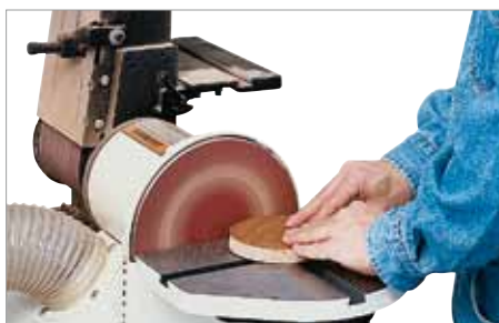
Tellerschleifen mit Kreisschleifeinrichtung
