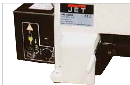
Stufenlose Drehzahlregelung über Potentiometer
