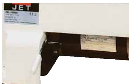
Schnellspannhebel für schnelles Riemenwechseln
