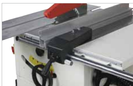
Stabiler Längsanschlag mit integrierter Feineinstellung auf Rundstange geführt
