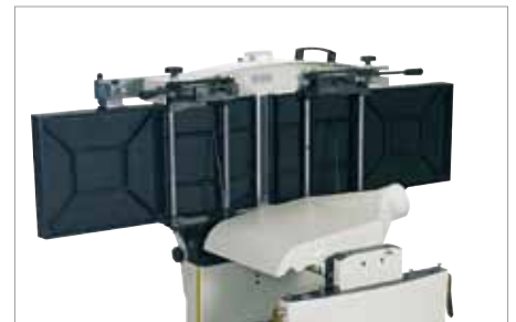
Sekundenschneller Wechsel von Abrichten auf Dickenhobeln
